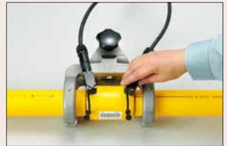
(公称外径315の場合)継手のターミナル部の保護キャップ(ソケット型のみ)を取り外し、電極径4.0mmの電極アダプターを接続します。
