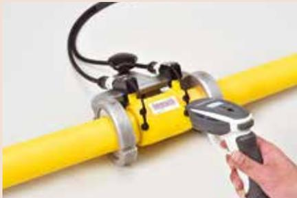
・液晶モニターに表示された継手情報が接続された継手と合致することを確認してください。
