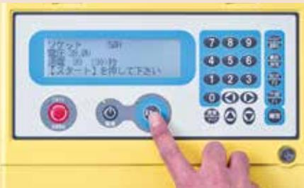
・通電中はブザーが鳴ります。尚、消音設定している場合は、ブザーは鳴りません。液晶モニターに通電残り時間が表示されます。
