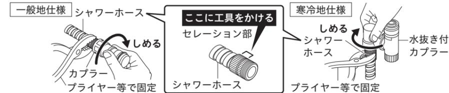
② カプラーのキャップをはずし、スライダを下に下ろしてから、プラグヘカチッと音がするまではめ込みます。(寒冷地仕様の場合はエルボが下向きになっていることを確認します。)取り付け後、カプラー(寒冷地仕様は水抜き付カプラー)を引っ張ってははずれないことを確認します。
