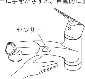
⑤ センサーまたはレバーハンドルを閉じて止水し、接続部からの水漏れがないことを確認してください。
