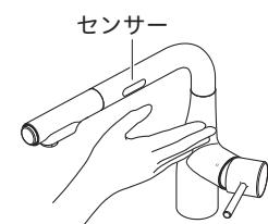
⑤ センサーまたはレバーハンドルを閉じて止水し、接続部からの水漏れがないことを確認してください。
