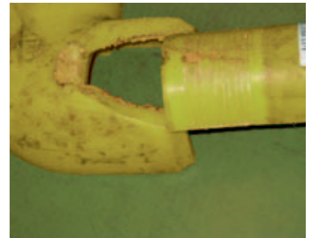
管表面の切削不良
