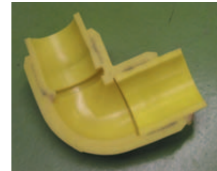
挿入不足と斜め挿入
